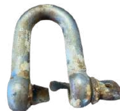
Manille acier rompue par corrosion du métal dû à l'environnement marin.
